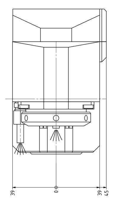
Spannzange / collet ER25 DIN6499 Spannbereich / clamping range: 1,0 - 16,0
