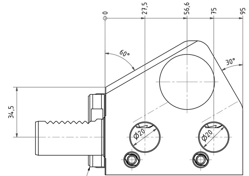
Aufgrund der Werkzeugaufnahme, kann die Ausrichtleiste nur hinten angebracht werden.
