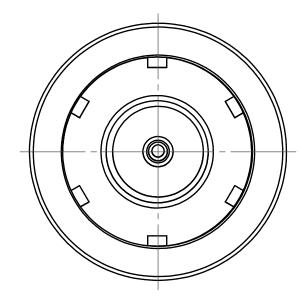
Spannzange / collet ER32 DIN6499 Spannbereich / clamping range: 2,0 - 20,0
