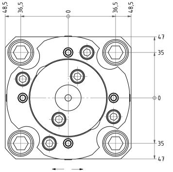
max. 0,5mm verstellmöglichkeit max. 0,5mm adjustability
