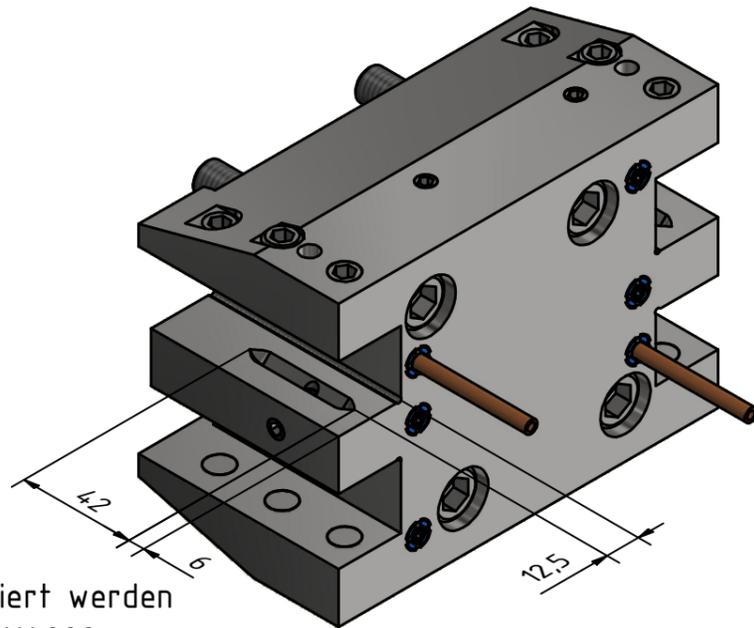
Kühlung nur mit Einsatz von Kühlrohren möglich
