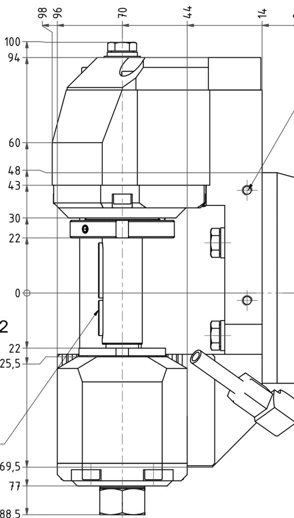
Gewindebohrungen für Winkelausrichtung.
