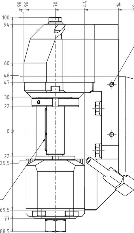
Gewindebohrungen für Winkelausrichtung.
