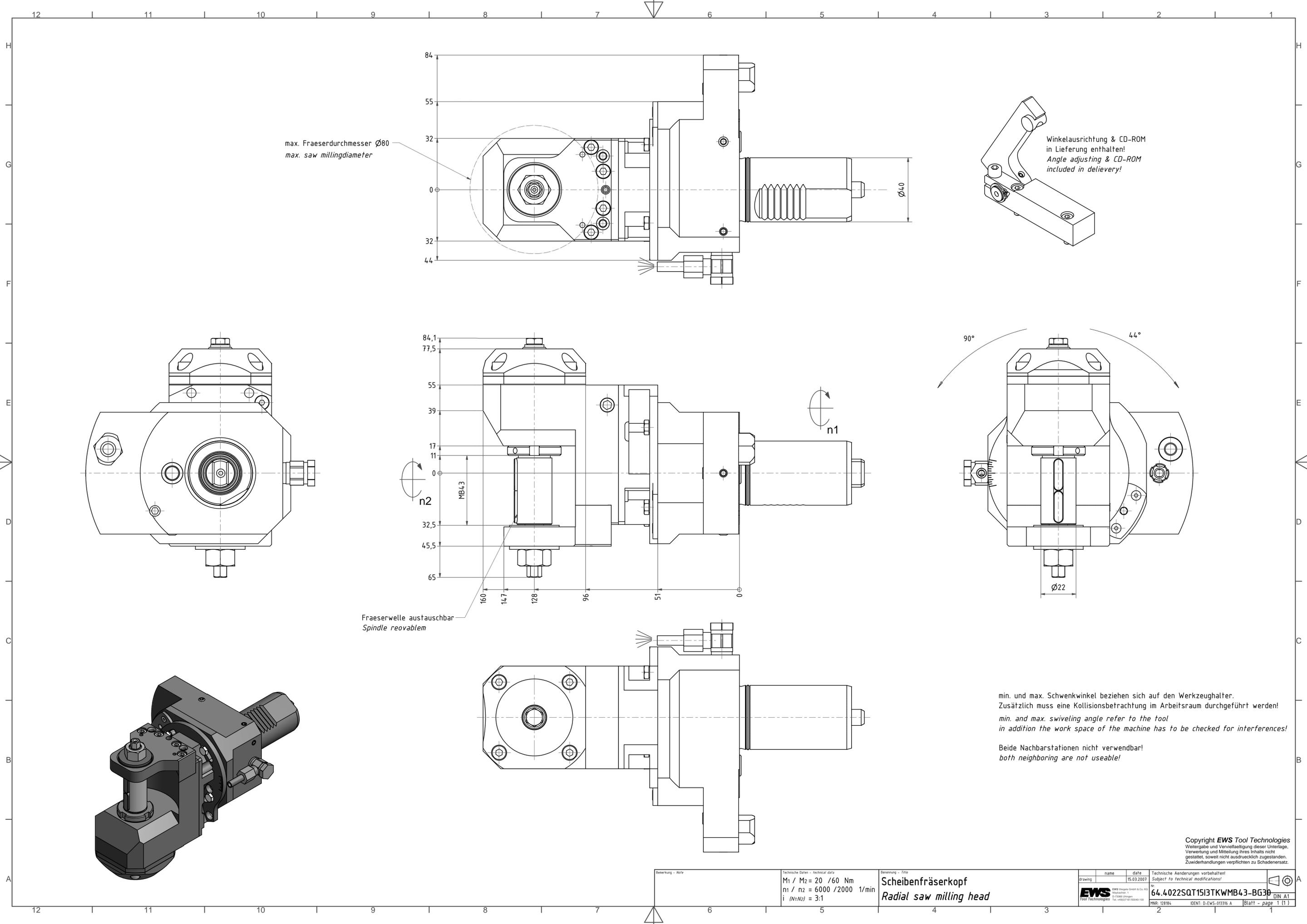
max. Fräserdurchmesser  $\varnothing 80$
