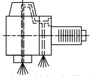
Innen- und Aussenkuehlung / Inside and outside coolant supply Kein Trockenlauf / No dry run Kuehlmittelfiltrierung<50µ / coolant filtration<50µ
