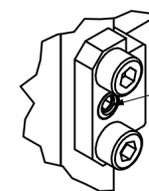
Ausrichtklotz ist über ein Exzenter einstellbar.
