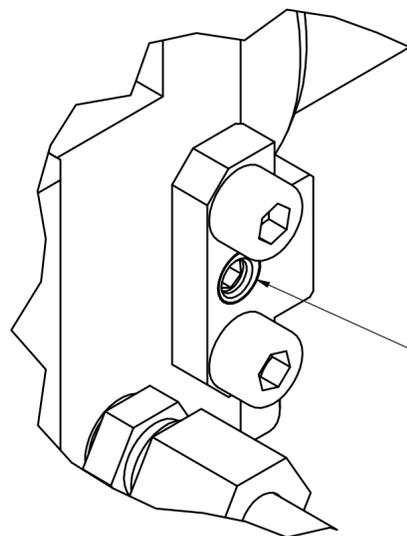
Ausrichtklotz ist über ein Exzenter einstellbar.
