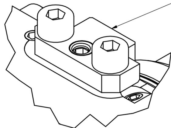
Ausrichtklotz ist über ein Exzenter einstellbar.
