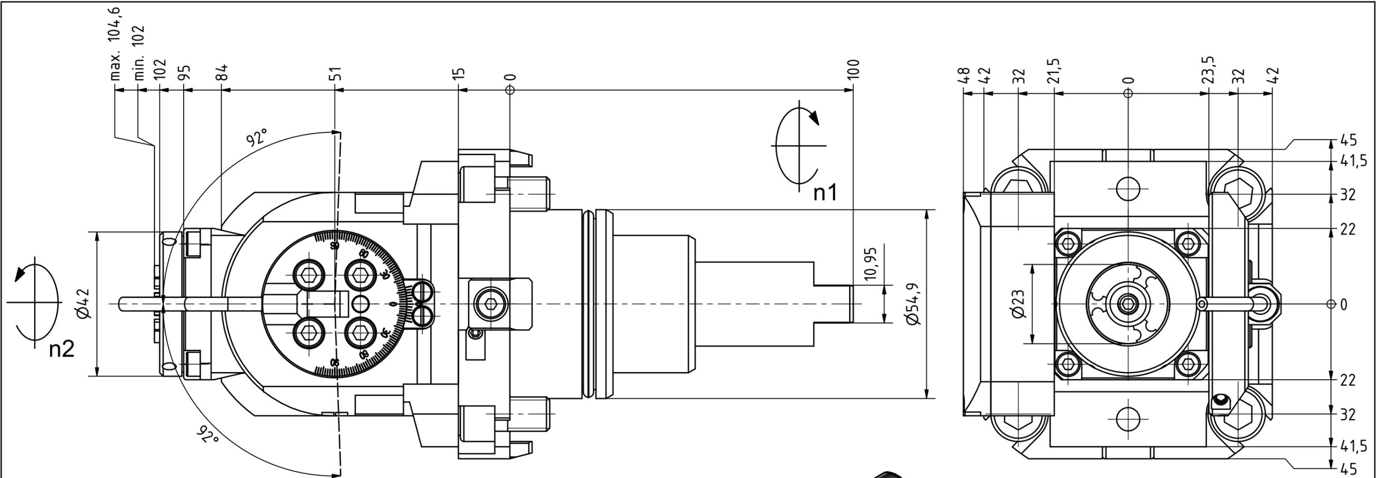
Schwenkbereich  $\pm 92^\circ$
