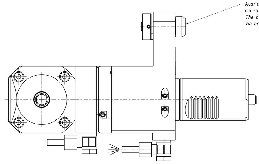
Ausrichtbolzen ist über ein Exzenter einstellbar.
