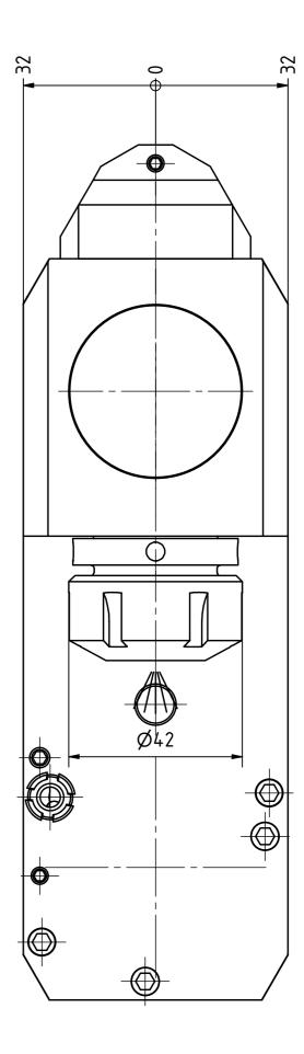
Spannzange / collet ER25 DIN6499 Spannbereich / clamping range: 1,0 – 16,0
