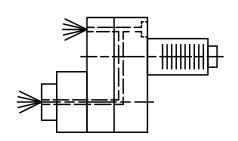
Innen- und Aussenkuehlung / Inside and outside coolant supply Kein Trockenlauf / No dry run Kuehlmittelfiltrierung<50µ / coolant filtration<50µ
