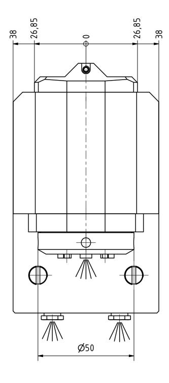
Spannzange / collet ER25 DIN6499 Spannbereich / clamping range: 1,0 - 16,0
