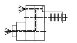
Innen- und Aussenkuehlung / *Inside and outside coolant supply* Kuehlmittelfiltrierung<50µ / *coolant filtration<50µ*
