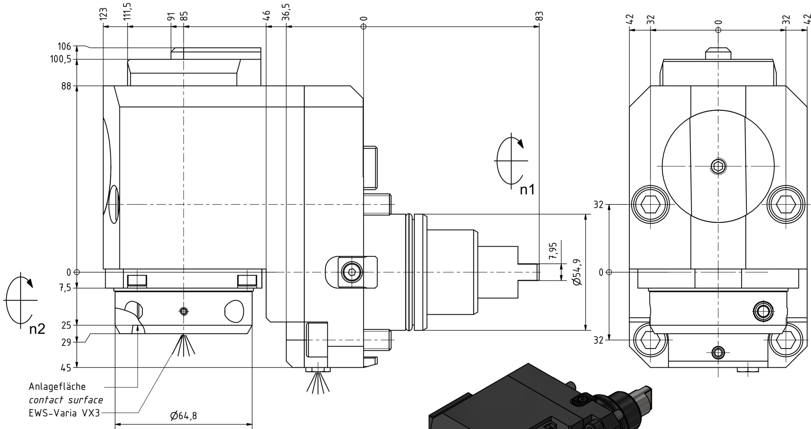
Bitte überprüfen Sie, ob der Werkzeughalter auf ihrem Revolver im Maschinenraum ohne Kollision durchschwenken kann. Bitte überprüfen Sie auch die Maße 100,5 und 106mm.
