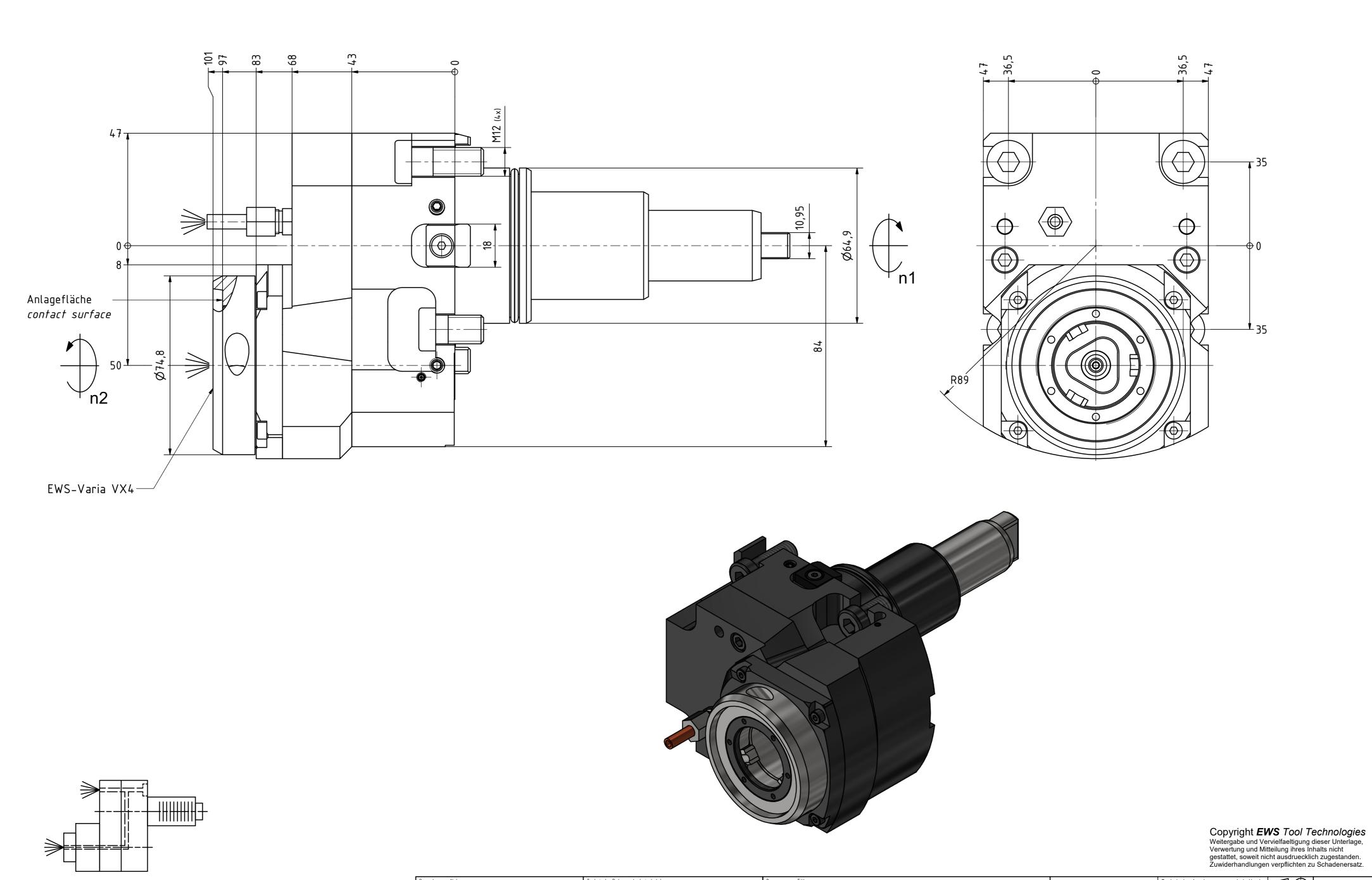
Innen- und Aussenkuehlung / Inside and outside coolant supply Kein Trockenlauf / No dry run Kuehlmittelfiltrierung<50p / coolant filtration<50p
