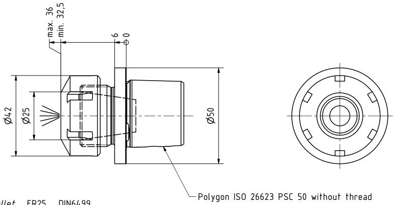
Spannzange / collet ER25 DIN6499 Spannbereich / clamping range: 1,0 – 16,0
