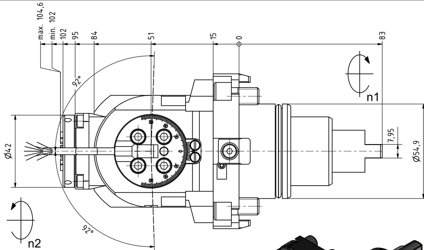
Schwenkbereich  $\pm 92^\circ$
