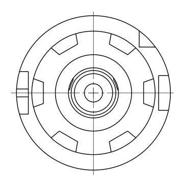
Spannzange / Collet ER16 DIN6499 Spannbereich / Clamping range: 1,0 - 10,0
