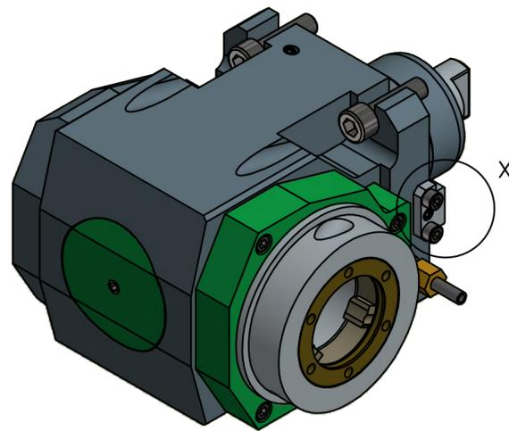
Ausrichtklotz ist über ein Exzenter einstellbar.
