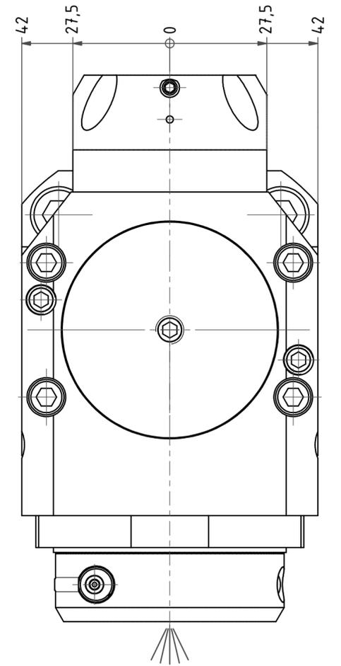
Ausrichtklotz ist über ein Exzenter einstellbar.
