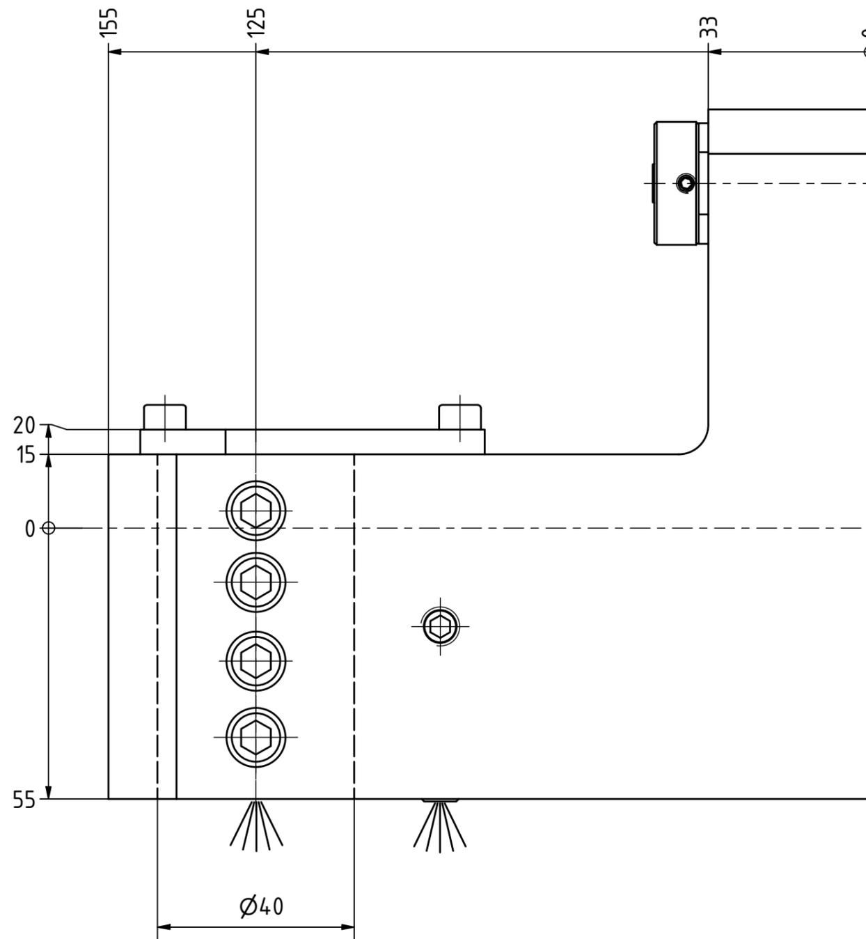
Ausrichtbolzen ist über einen Exzenter einstellbar.
