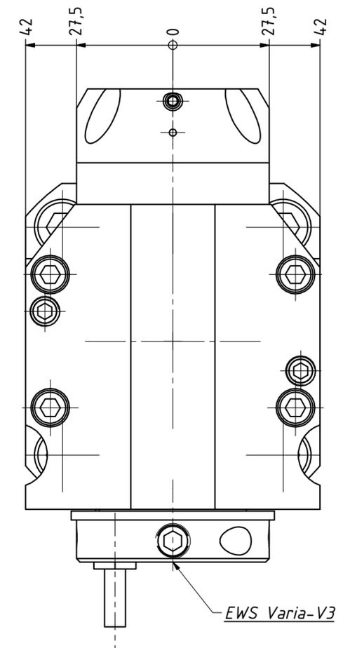
Ausrichtklotz ist über ein Exzenter einstellbar.
