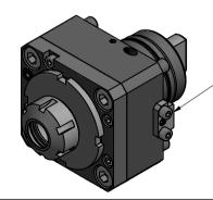
Ausrichtklotz ist über ein Exzenter einstellbar. The block is adjustable via eccentric.
