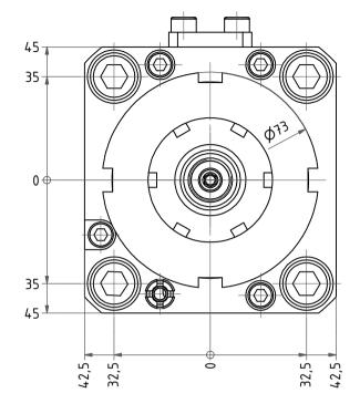
Spannzange / collet ER25 DIN6499 Spannbereich / clamping range: 1,0 - 16,0
