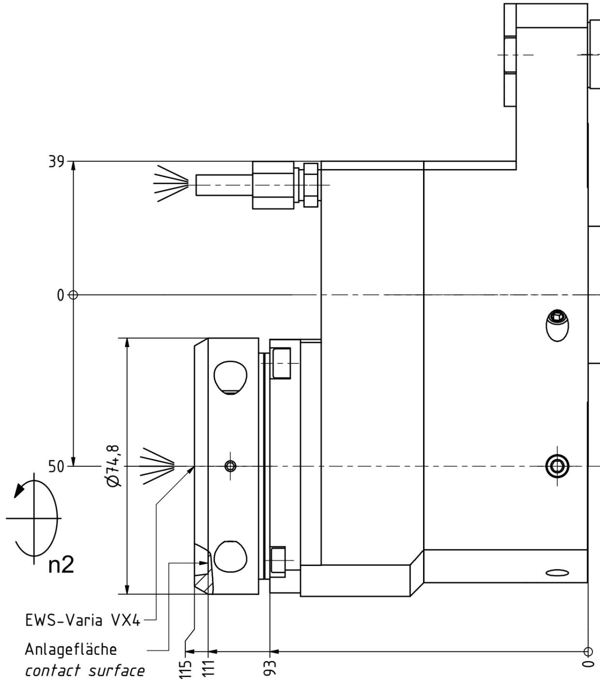
Ausrichtbolzen ist über einen Exzenter einstellbar.
