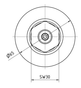
Spannzange / collet ER20 DIN6499 Spannbereich / clamping range: 1,0 – 13,0
