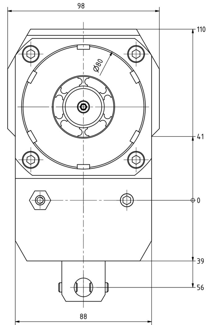
Bei Sternrevolver muss der zweite Pin entfernt werden !
