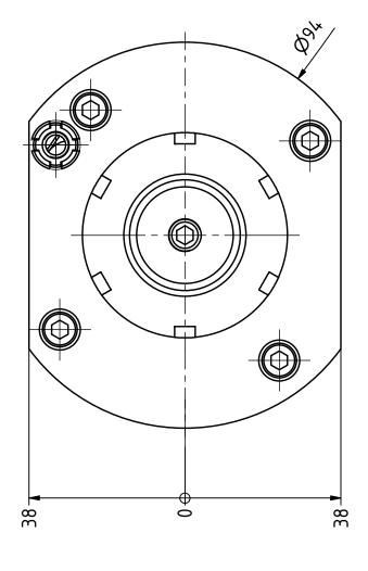
Spannzange / collet ER32 DIN6499 Spannbereich / clamping range: 2,0 - 20,0
