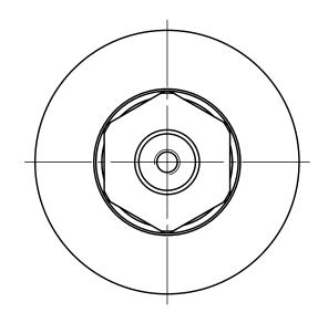
Spannzange / collet ER20 DIN6499 Spannbereich / clamping range: 1,0 - 13,0
