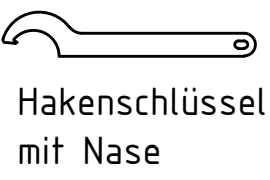
Hakenschlüssel mit Nase Hook wrench with nose end DIN1810 A 45x50
