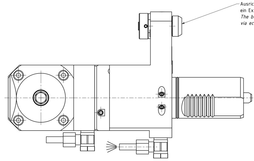
Ausrichtbolzen ist über ein Exzenter einstellbar.
