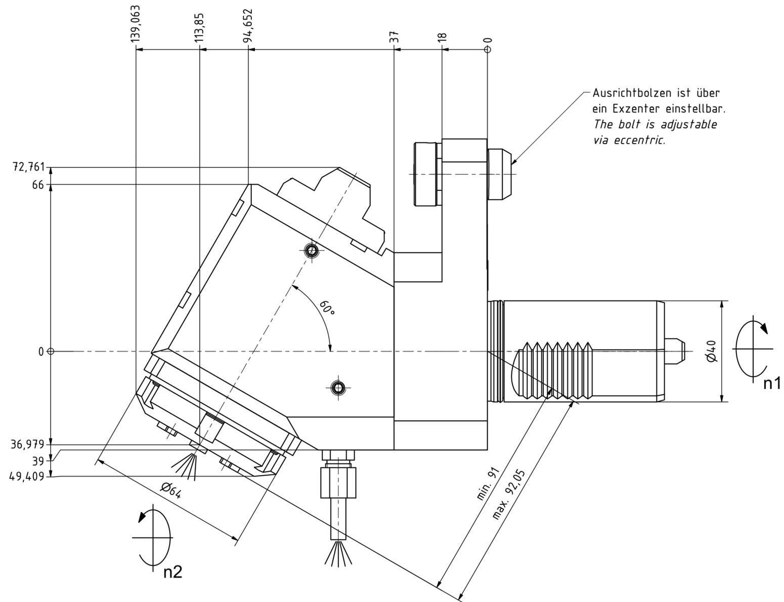
Ausrichtbolzen ist über ein Exzenter einstellbar.
